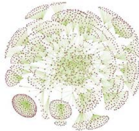
(b) Iedere router in het internet is bereikbaar van iedere andere router. Het netwerk is verbonden . Bron: P. Mahadevan et al. Systematic topology analysis and generation using degree correlations. ACM SIGCOMM Computer Communication Review , 36(4):135-146, 2006.
